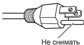
Данный прибор оснащен трехконтактной штепсельной вилкой с заземлением. Не удаляйте контакт заземления. Эту вилку можно подключить только к электрической розетке с заземлением (это мера безопасности). Если не удастся вставить штепсельную вилку в розетку до упора, обратитесь к продавцу прибора.
