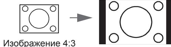
2. **Реальн.:** изображение проецируется с исходным разрешением, а его размер подгоняется к размеру экрана. Если входной сигнал имеет меньшее разрешение, размер проецируемого изображения окажется меньше, чем при увеличении до размера полного экрана. Для увеличения размера изображения можно также отрегулировать настройки масштаба или передвинуть проектор подальше от экрана. После этого может также потребоваться повторная настройка фокуса проектора.
